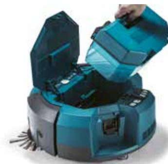
Le conteneur de récupération de poussière de 2,5 l (DRC200Z) / 3,0 l (DRC300Z) se laisse enlever facilement pour le nettoyage. Équipé d'un filtre. Les petites particules de saleté atteignent la partie supérieure du récipient grâce au système d'aspiration. Les grosses particules de saleté sont collectées dans la partie inférieure du conteneur.
