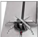
Butée angulaire avec profil de guidage long et ajustement précis, réglable de 0° à 60° avec crans d'arrêt. Pour les coupes d'onglet jusqu'à 480 mm.
