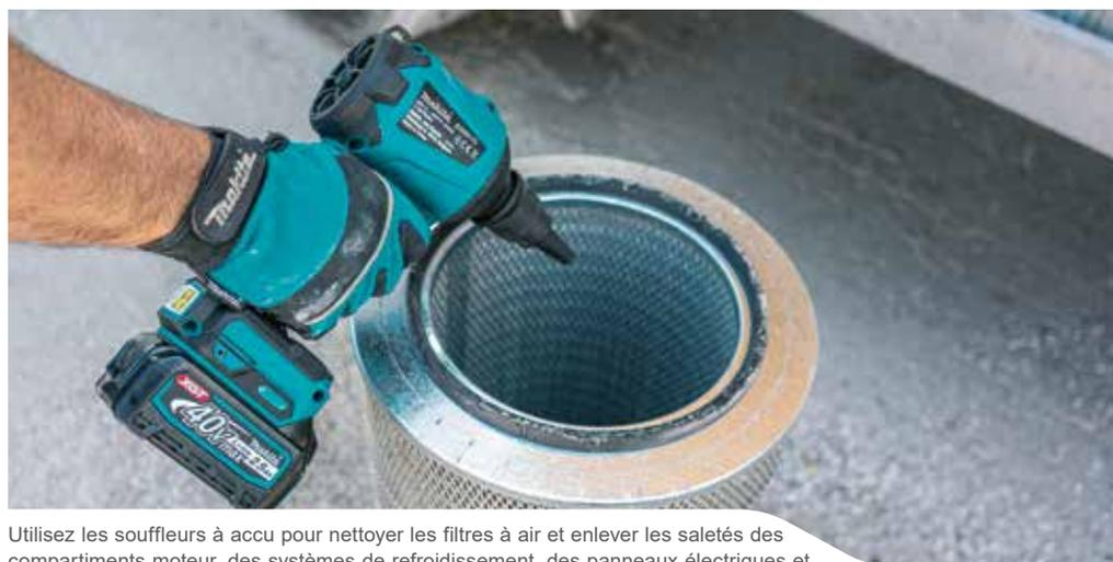
Utilisez les souffleurs à accu pour nettoyer les filtres à air et enlever les saletés des compartiments moteur, des systèmes de refroidissement, des panneaux électriques et des zones difficiles d'accès par des machines lourdes.
