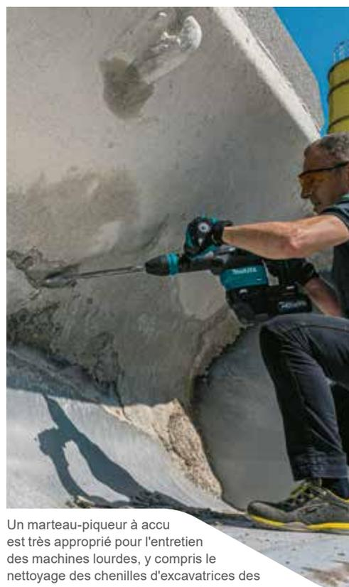
Un marteau-piqueur à accu est très approprié pour l'entretien des machines lourdes, y compris le nettoyage des chenilles d'excavatrices des lames de bulldozers et des godets de chargeurs.
