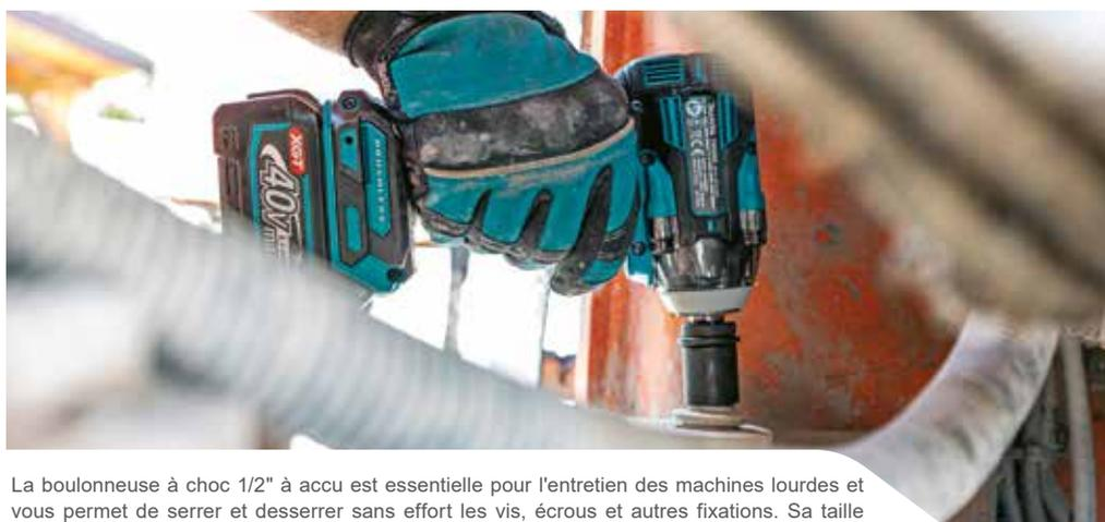
La boulonneuse à choc 1/2" à accu est essentielle pour l'entretien des machines lourdes et vous permet de serrer et desserrer sans effort les vis, écrous et autres fixations. Sa taille compacte et sa portabilité la rendent idéale pour travailler sur divers composants de machines dans des espaces restreints.
